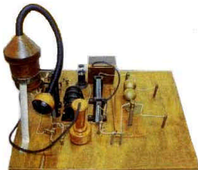
FIGURA 2 - TRANSMISSOR DE ONDAS
