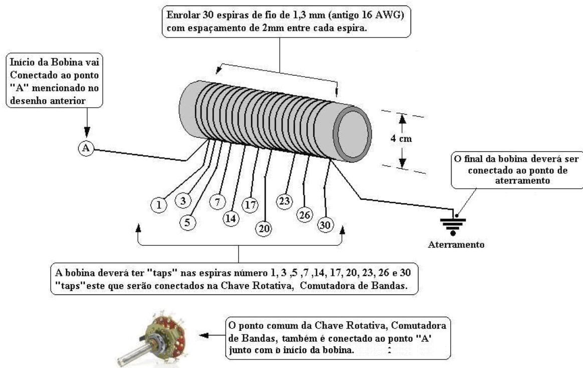
Com estes detalhes, você poderá montar este simples e eficiente acoplador de antenas, que será um excelente apoio nas suas escutas entre 3 e 30 MHz, quando estiver atuando sobre uma antena G5RV.
