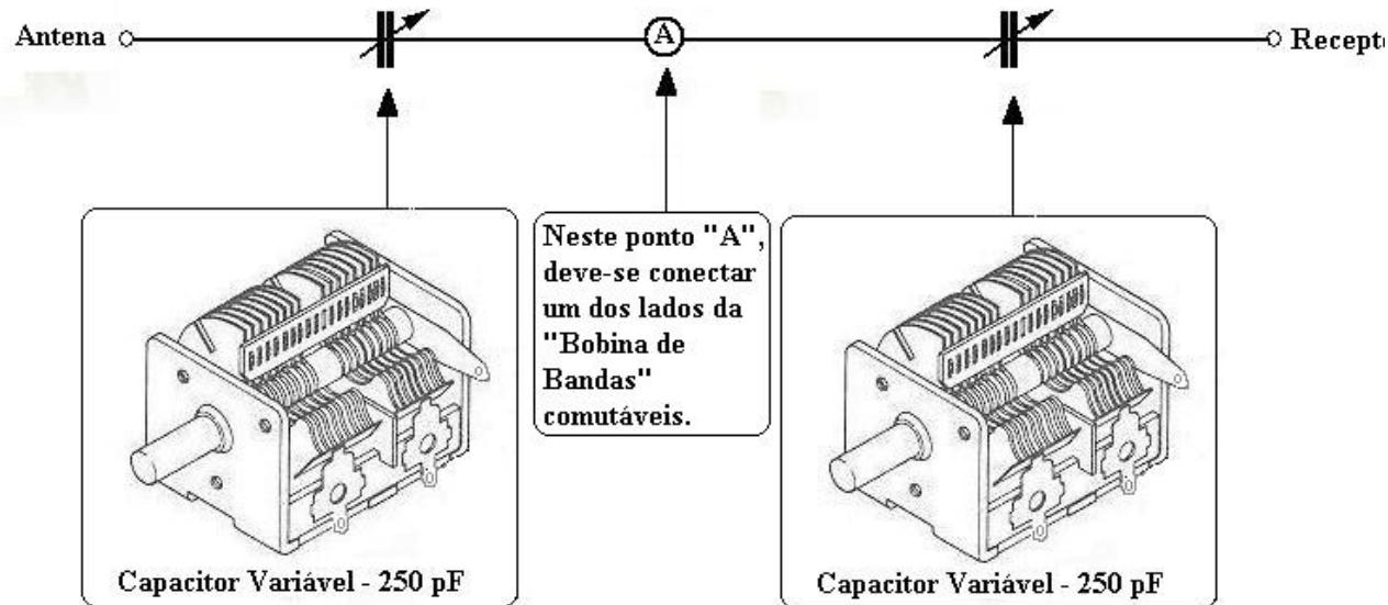
Podemos afirmar que a “alma” deste acoplador, está na bobina de sintonia, que formará a perna central do “T”, interligando o circuito à terra.
