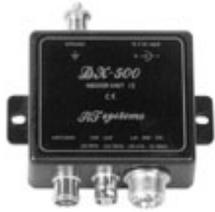
2) Unidade DX500/2, Indoor (interna), protegida contra curto circuitos no cabo de antena e saídas, contra inversão de polaridade e picos de tensão, além de um filtro de interferências, na alimentação de 12 Vcc, que permite a conexão a dois receptores, um para
