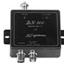
1) Unidade DX500/1, Indoor (interna), protegida contra curto circuitos no cabo de antena e saídas, contra inversão de polaridade e picos de tensão, além de um filtro de interferências, na alimentação de 12 Vcc, que permite a
