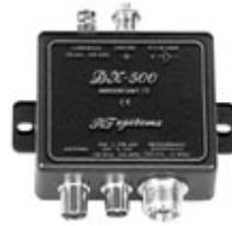
3) Unidade DX500/3, Indoor (interna), protegida contra curto circuitos no cabo de antena e saídas, contra inversão de polaridade e picos de tensão, além de um filtro de interferências, na alimentação de 12 Vcc, que permite a conexão a três receptores, pois fornece três saídas; uma
